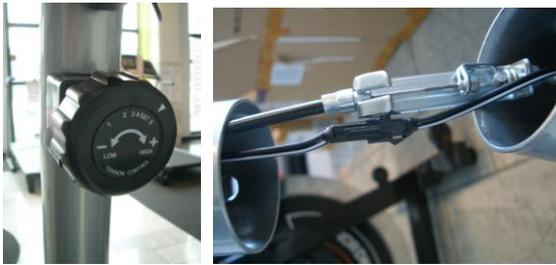
Begynn med å sette regulatoren på tyngste belastning. For å montere wirene riktig sammen hektes wiren fra regulatoren inn på sluttstykket helt øverst på wiren som kommer nedenfra. Dra så wiren opp slik at den kommer inn i sporet som på bildet nedenfor, det kan være at det må brukes litt krefter da det sitter kraftige magneter i andre enden. Er monteringen gjort riktig så vil den nedre wiren følge med den øvre wiren når det justeres på motstandsregulatoren.
